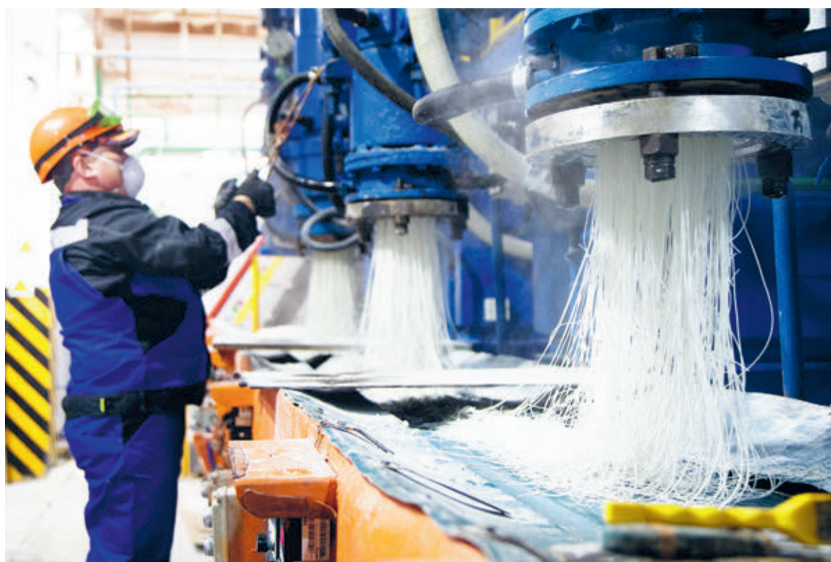
Изначально высокотехнологичный продукт напоминает «спагетти» белого цвета, которые ложатся длинной лентой на конвейер.
